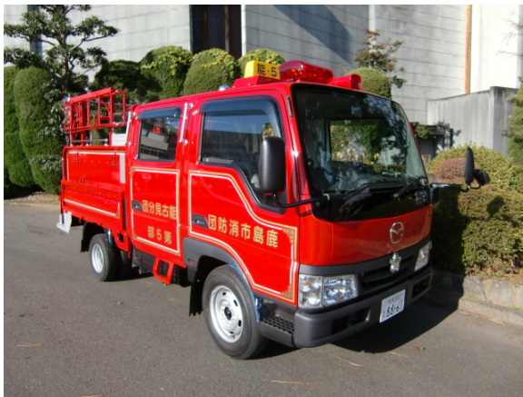
○小型動力ポンプ積載車
